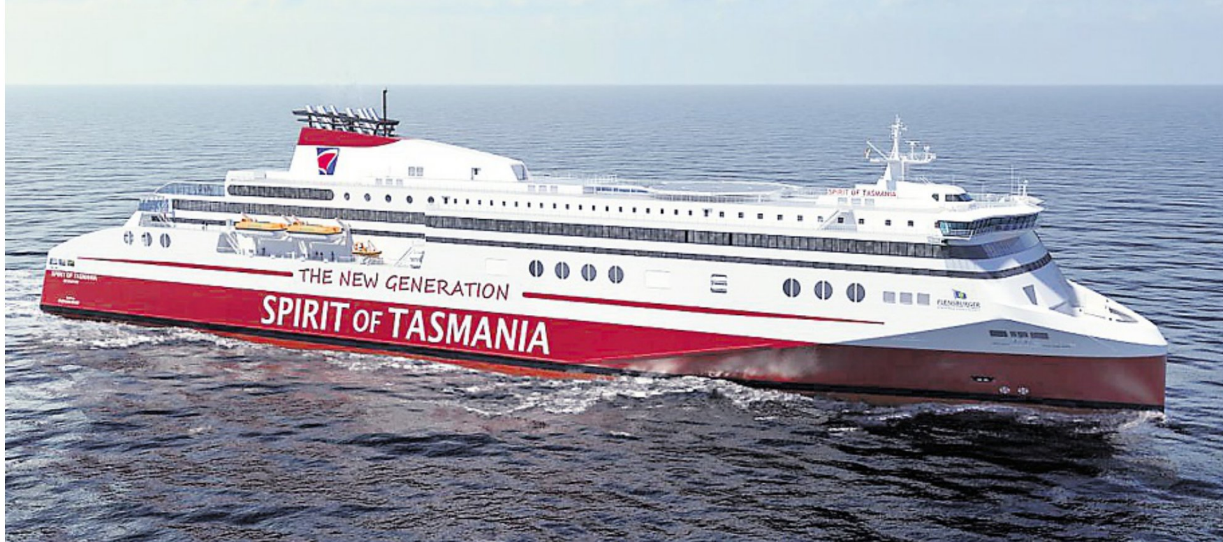
Die nächste Generation: 212 Meter lang werden die beiden neuen Fähren für „Down Under“; sie haben 284 Kabinen und Platz für 2000 Passagiere.
